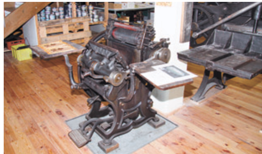
Die Tiegeldruckmaschine arbeitet im Fläche gegen Fläche Prinzip.
